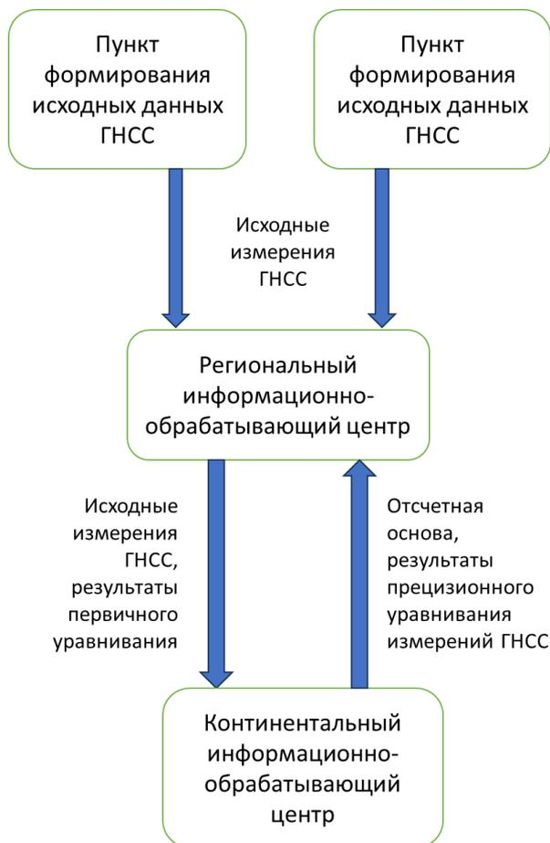
Рисунок 3.1. Функциональная схема взаимодействия центров сбора и обработки данных
